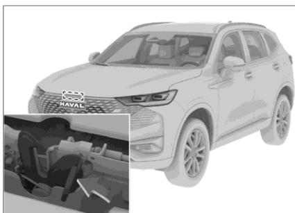
3. Saque el puntal del soporte e inserte el extremo delantero en el hueco del cofre para apuntalarlo.
