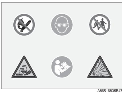
Esta etiqueta se encuentra en la batería para informarle de las siguientes precauciones antes de instalar, extraer o inspeccionar la batería:
