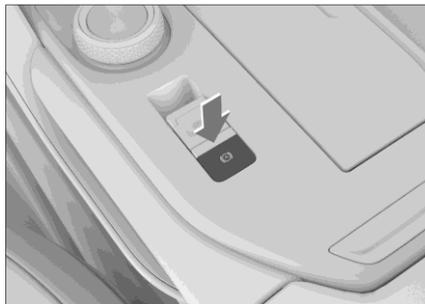
La retención automática del vehículo (AVH) elimina la necesidad de que el conductor pise el pedal del freno durante periodos prolongados o accione el freno de mano electrónico con frecuencia cuando el vehículo está en una pendiente, en un semáforo en rojo o en movimiento y detenido. Permite al conductor conducir con mayor comodidad y reduce el riesgo de que el vehículo ruede.
