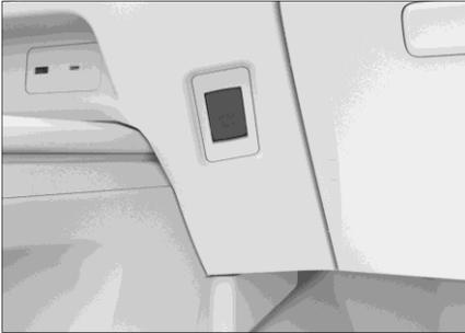
Se encuentra en el lado derecho del panel de instrumentos auxiliar. Para utilizarlo, presione el extremo superior del gancho portaequipajes y suéltelo, y el gancho se abrirá suavemente. Gírelo hacia abajo.
