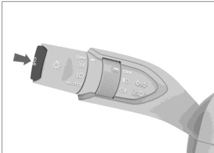
La función automática de luces bajas-altas puede cambiar automáticamente entre las luces altas y bajas en función de la velocidad actual del vehículo y la luminosidad del entorno.
