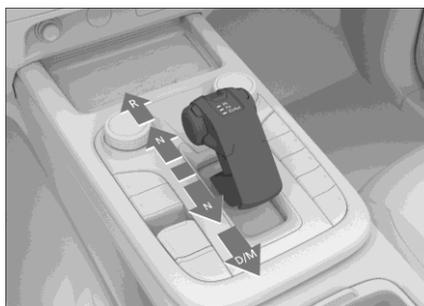
Mueva la palanca de cambios en la dirección deseada y suéltela para volver automáticamente a la posición de punto muerto.
