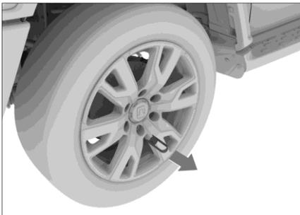
En los vehículos equipados con cubiertas de birlos de la rueda, utilice la herramienta de desmontaje suministrada con el vehículo para desmontarlas.
